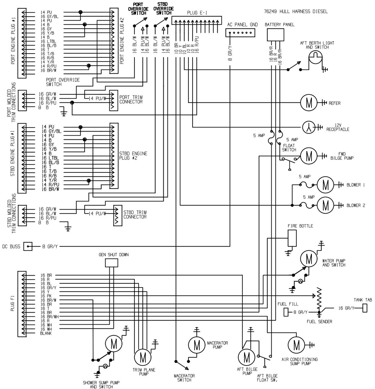
NOTE -  $\perp$  SYMBOL REPRESENTS A BLACK CONDUCTOR TO THE GROUND BUSS
